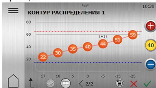
Настройки температуры подачи при различной температуре наружного воздуха.
